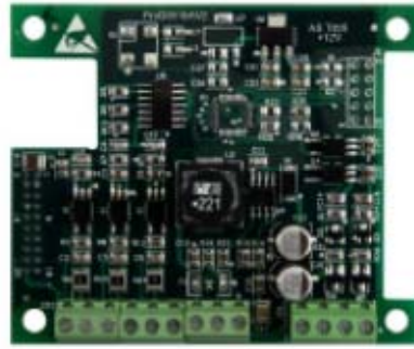
그림 4.3 ABZ 증분형 12V PG카드 단자 배열
