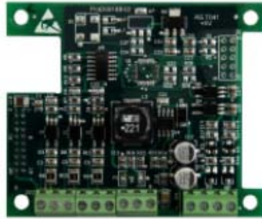
그림 4.5 ABZ 증분형 5V PG카드 단자 배열
