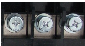
Fig. 3.3 18.5kW/22kW 메인회로 단자 배열
