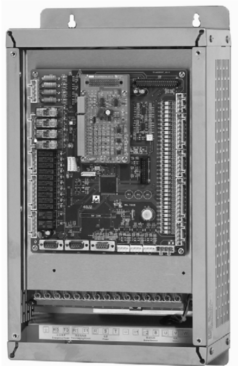
Figure 2.5 엘리베이터 통합 컨트롤러 외형(22KW) 케이스 있는구조의 예시)
